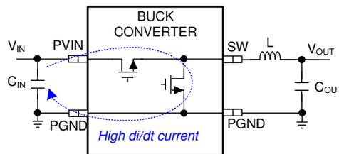
**Figure 10-1. Buck Converter High di / dt Path**
