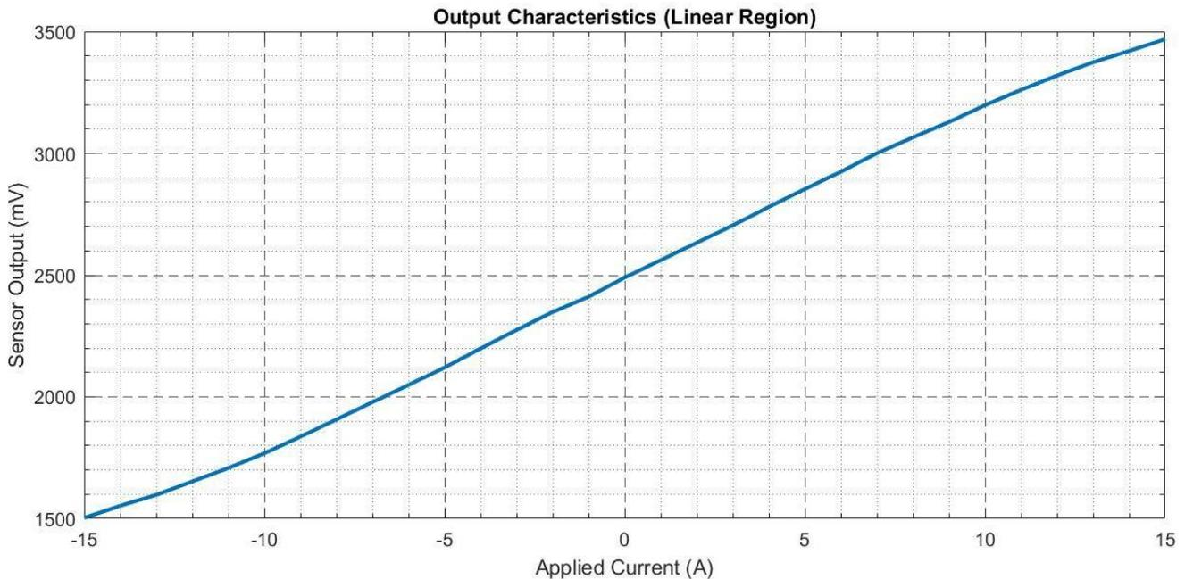
Figure 4. Output Characteristics of the sensor DS10.2m
